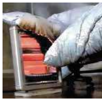
電気ストーブに布団が接触して過熱される様子
