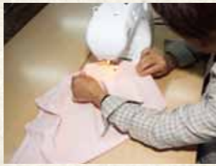
②出来上がり線A(型紙参照)に沿って縫います。縫い終わりは返し縫いを。
