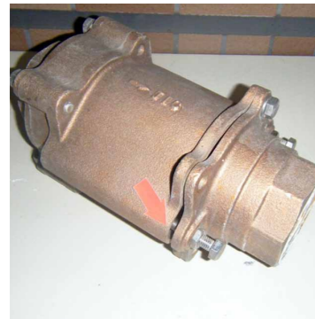
凍結により破損した圧力調整弁
