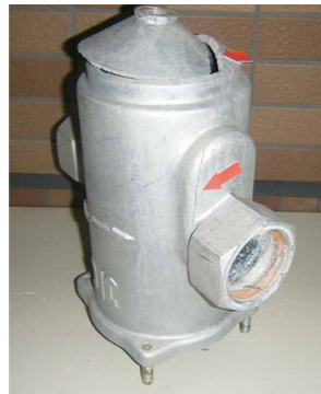
凍結により破損したストレーナー
