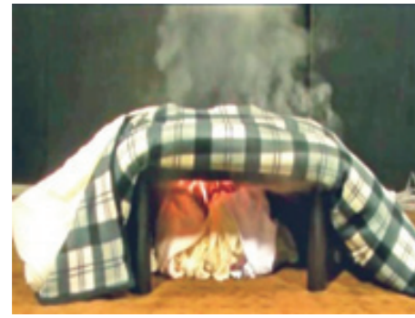
こたつ内に入れた衣類から発火しました (写真提供: nite・製品安全センター)
