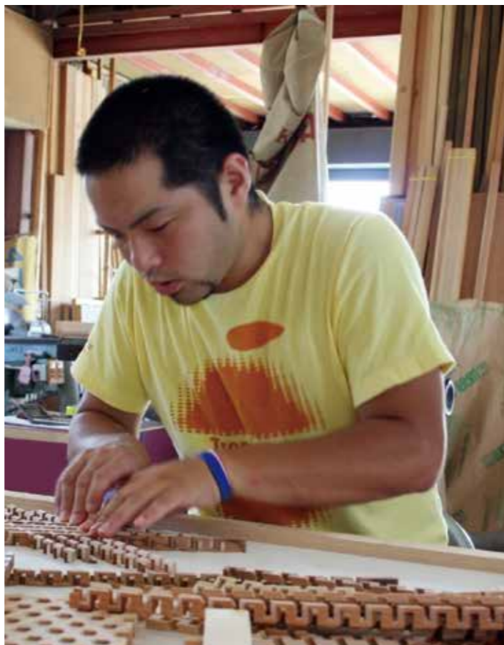
0.1ミリずれると完成しない神業的に難しいという目潰籠目の製作
