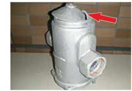
凍結により破損したストレーナー（矢印部分）
